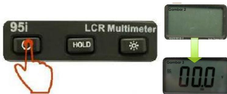
Gambar 3.1 Cara menghidupkan multimeter.
