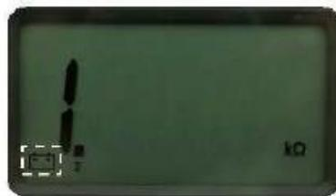
Gambar 2.1 Simbol baterai lemah pada layar LCD.
