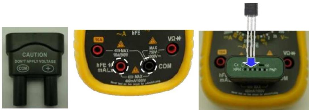
Gambar 4.8 Pengukuran nilai hFE dengan multimeter.
