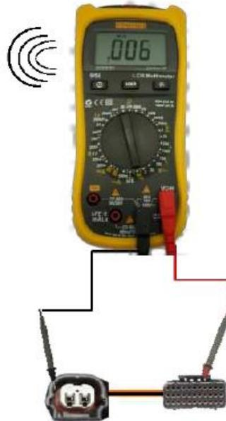
Gambar 4.2 Pengecekan kontinuitas dengan *buzzer*.
