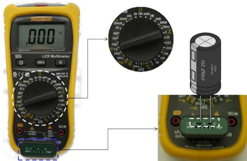
Gambar 4.9 Pengukuran kapasitor.
