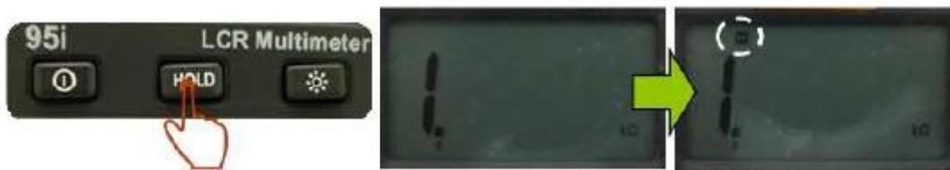
Gambar 3.2 Mengunci data pada multimeter.
