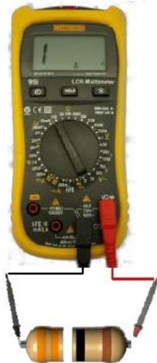
Gambar 4.3 Pengukuran nilai hambatan resistor dengan multimeter.
